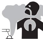
Beim Schweißen entstehen Rauchgase bzw. toxische Dämpfe. Sorgen Sie daher immer für ausreichende Frischluftzufuhr, technische Belüftung oder ein zugelassenes Atemgerät. Schweißen Sie nur in gut belüfteten Hallen, im Freien oder in geschlossenen Räumen mit ausreichend starker Absaugung, die den aktuellen Sicherheitsstandards entspricht.
