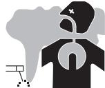
Dampen, gassen en stof uitgestoten tijdens het lassen zijn gevaarlijk voor de gezondheid. Zorg voor voldoende ventilatie, soms is toevoer van verse lucht tijdens het lassen noodzakelijk. Een lashelm met verse luchtaanvoer kan een oplossing zijn als er onvoldoende ventilatie is.
