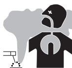
Выделяемые при сварке дым, газ и пыль опасны для здоровья. Вентиляция должна быть достаточной, и может потребоваться дополнительная подача воздуха. При недостаточной вентиляции можно воспользоваться маской сварщика-респиратором.
